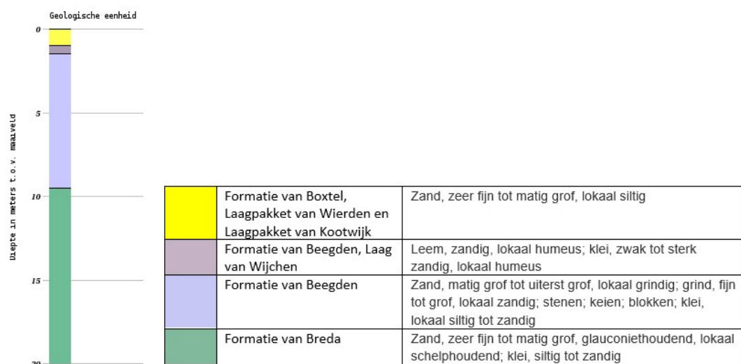
Figuur 4 Opbouw ondergrond tpv Groene Buffer
