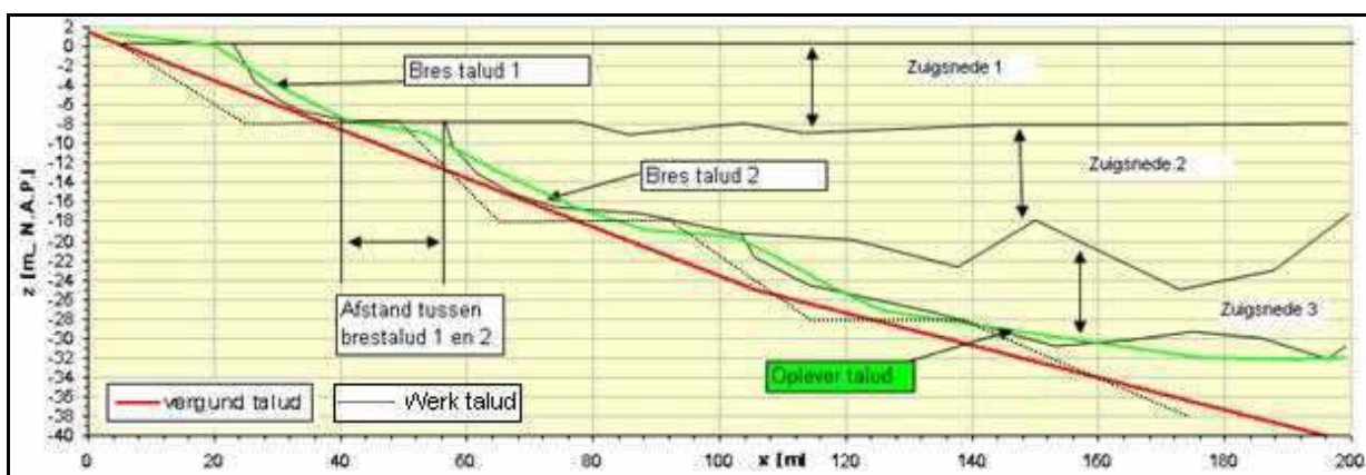
Figuur 3.2 Voorbeeld Schematische voorstelling laagsgewijs aanzuigen van het talud
