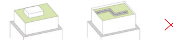
Geen losse (installatie-) opbouwen en vrijliggende luchtpijpen op de daken
