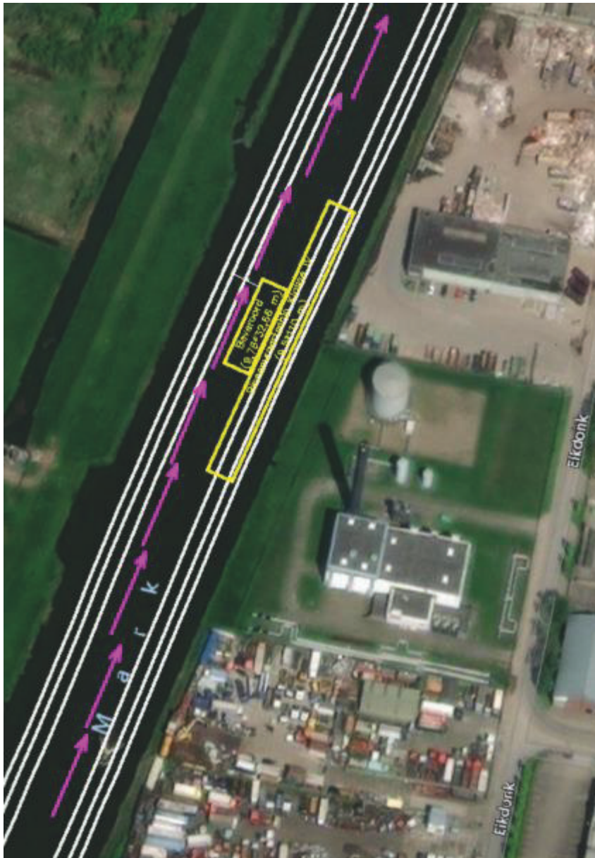
Figuur 2: Situatie met baggerwerkzaamheden aan binnenvaartschip aan buitenzijde (vrij ruimte vaargeul: ca 10 meter)
