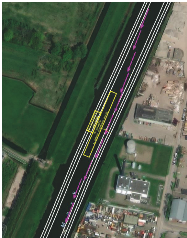
Figuur 1: Situatie met baggerwerkzaamheden met ponton aan buitenzijde (vrij ruimte vaargeul: ca 15 meter)
