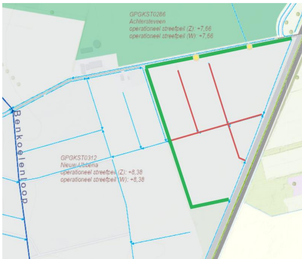
Figuur 1: Dempingen (1) weergegeven met rode lijnen, verbredingen (2) weergegeven met groene lijnen, aangelegde dammen met duikers (3) weergegeven met gele cirkels.
