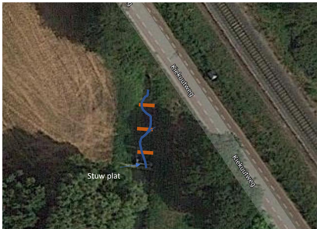
Figuur 9.2. Principeschets van een vispassage benedenstrooms van de stuw
