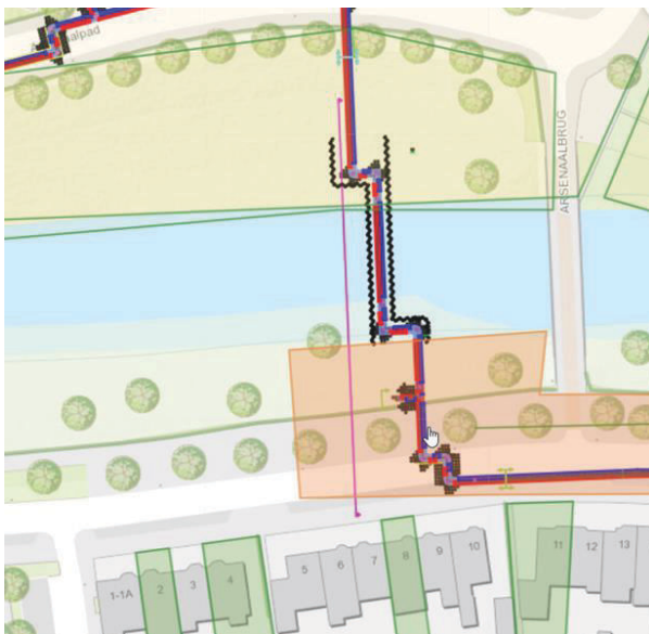
Figuur 2: Detailtekening van de zinker aan de Vrededeburchsingel.
