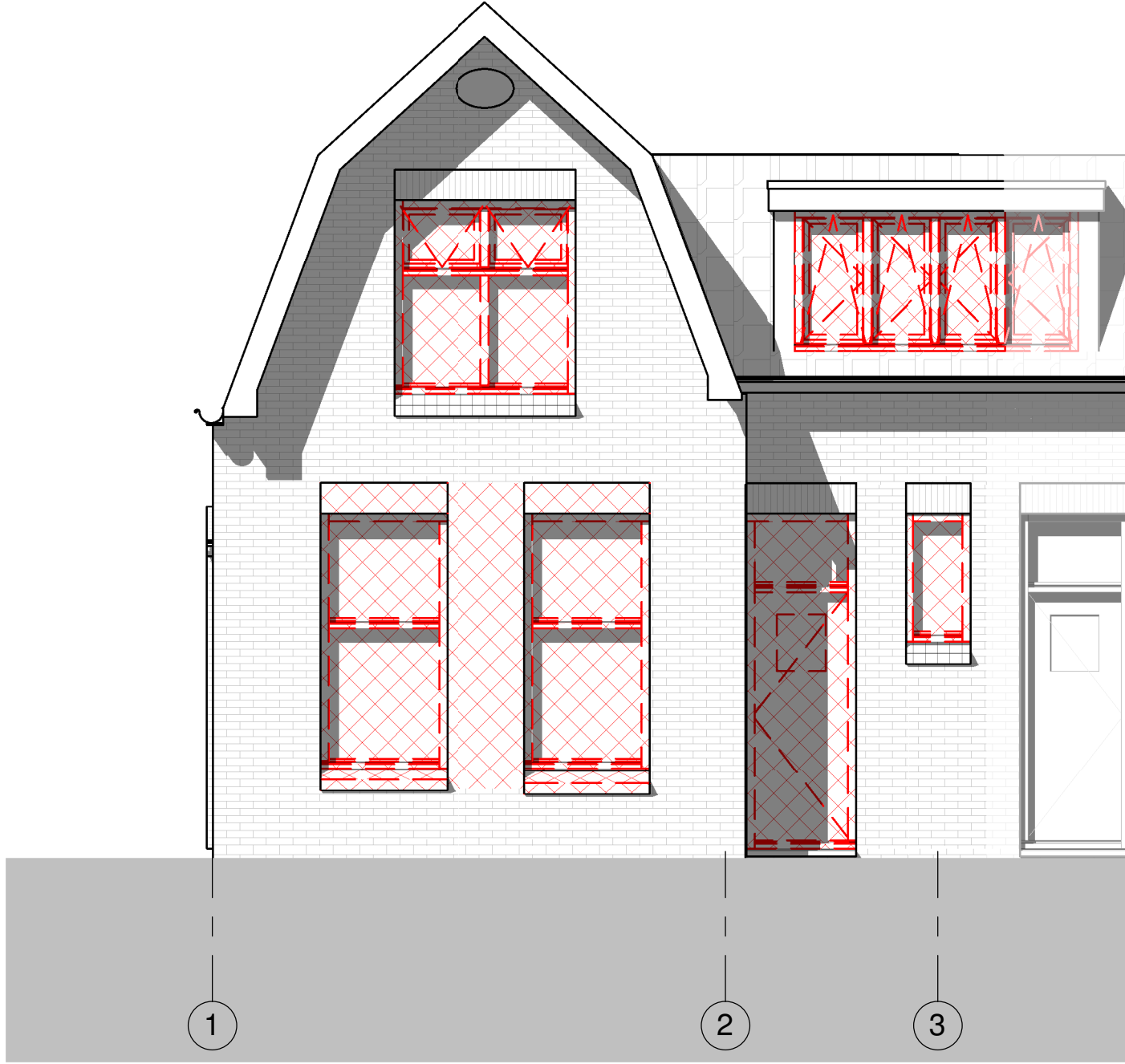
Zichtbaar welke kozijnen vervangen worden
