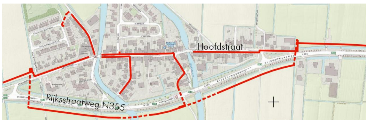
Figuur 1: Globale weergave waterleidingtracé, gestuurde boringen weergegeven met rode stippellijnen.
