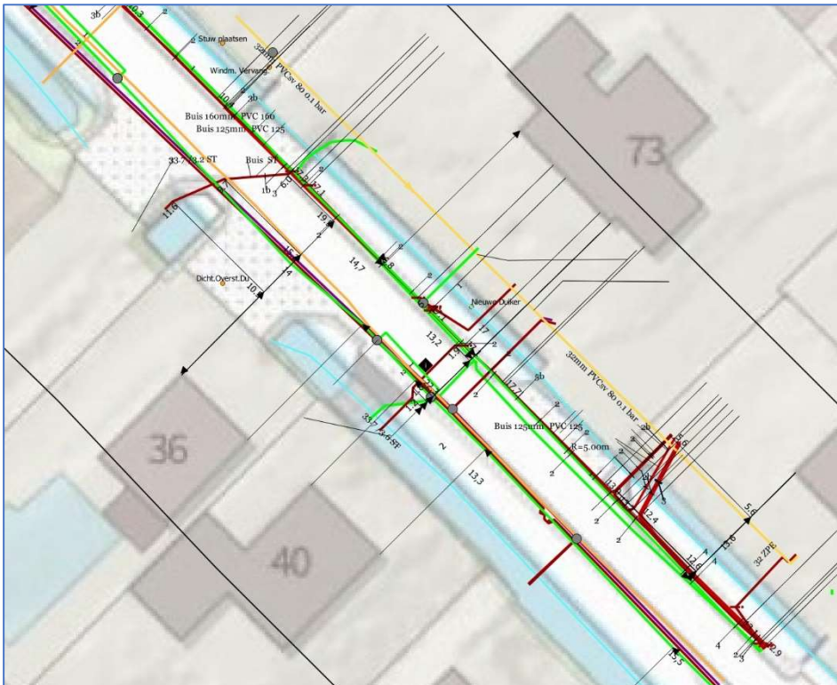
Figuur 13: Locatie kabels en leidingen in projectgebied Peilopzet voorzieningen Knibbelweg
