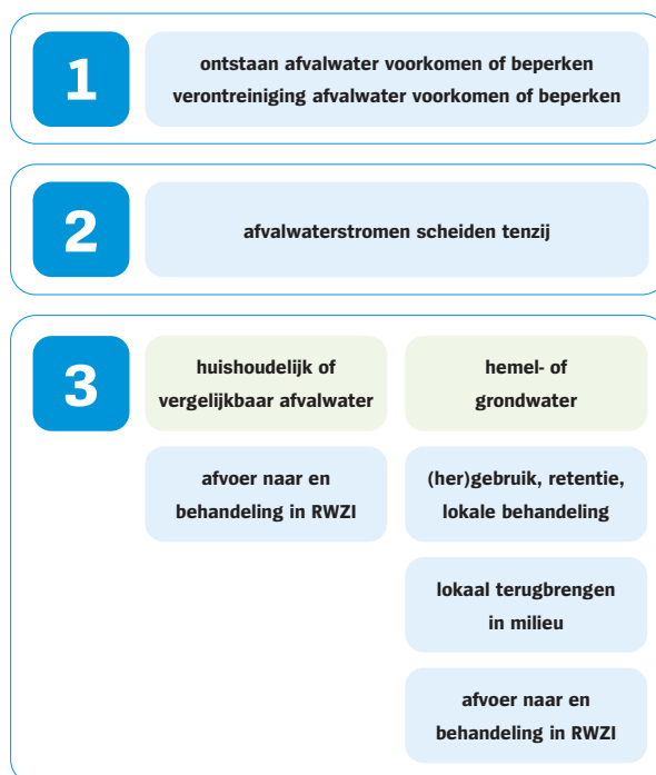
Figuur 3 5: voorkeursvolgorde omgang met afvalwater
