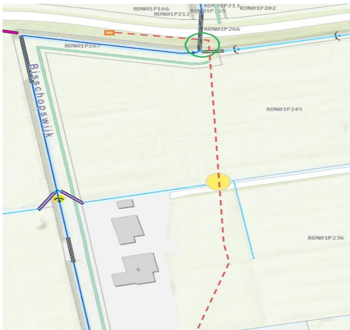
Figuur 1: Gewenste kabeltracé is weergegeven met rode stippellijn, de te plaatsen verdeelkast is weergegeven met oranje vierkant, de twee duikerkruisingen zijn weergegeven in de groene cirkel en de slootkruising van de secundaire watergang is weergegeven met de gele cirkel. Het onderhoudspad van het waterschap is weergegeven met een groene lijn langs de Bisschopswijk.
