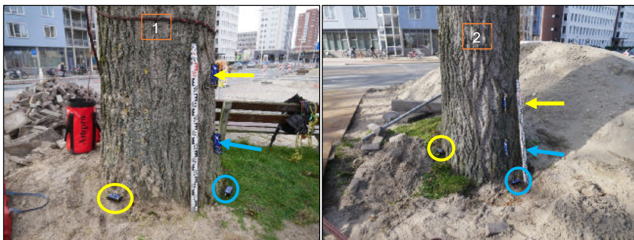
Foto 14 en 15: Links een beeld van de sensorplaatsing bij boomnummer 1. Rechts een beeld van de sensorplaatsing bij boomnummer 2. De inclinometers zijn met cirkels de elastometers zijn met pijlen aangeduid. De kleurcodering correspondeert met de kleurcode in tabel 2.
