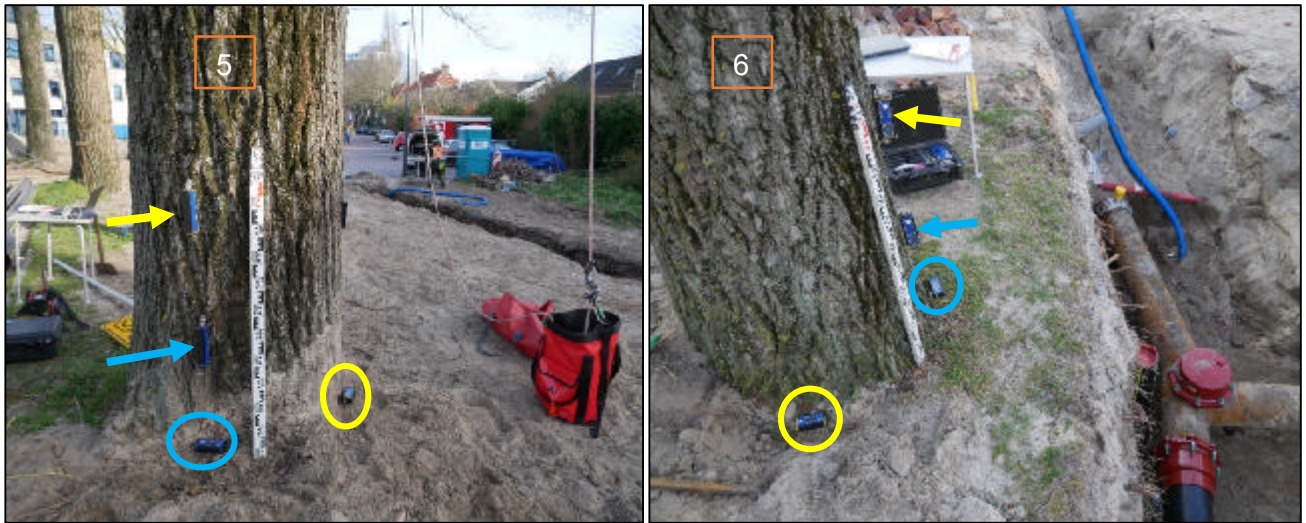
Foto 18 en 19: Links een beeld van de sensorplaatsing bij boomnummer 5. Rechts een beeld van de sensorplaatsing bij boomnummer 6. De inclinometers zijn met cirkels de elastometers zijn met pijlen aangeduid. De kleurcodering correspondeert met de kleurcode in tabel 2.
