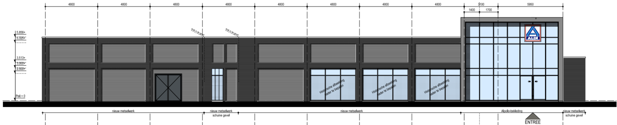
Figuur 8: Gevelaanzicht voorgevel supermarktgebouw in nieuwe situatie (bron: Den Hollander Bouwadvies en Ontwerp).
