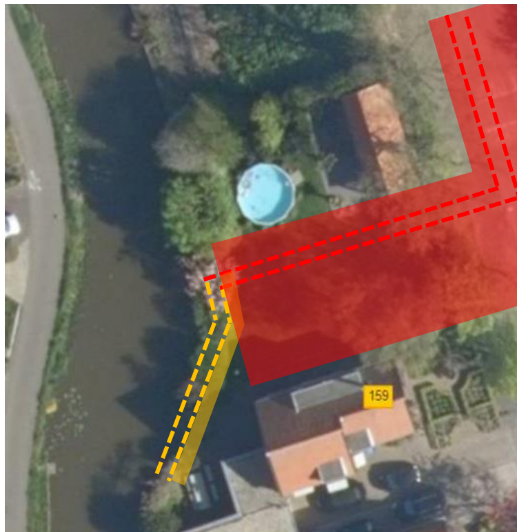
Figuur 4-7 Indicatie benodigde vrije ruimte. (Kistdam: Oranje, Dijklichaam: Rood)
