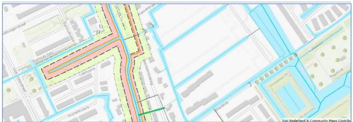
Figuur 3-1 Legger Waterkering, rood waterstaatswerk, groen beschermingszone
