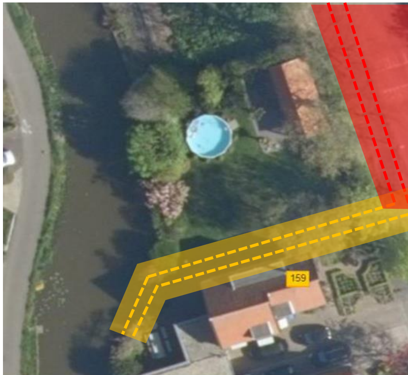
Figuur 4-9 Indicatie benodigde vrije ruimte. (Kistdam: Oranje, Dijklichaam: Rood)
