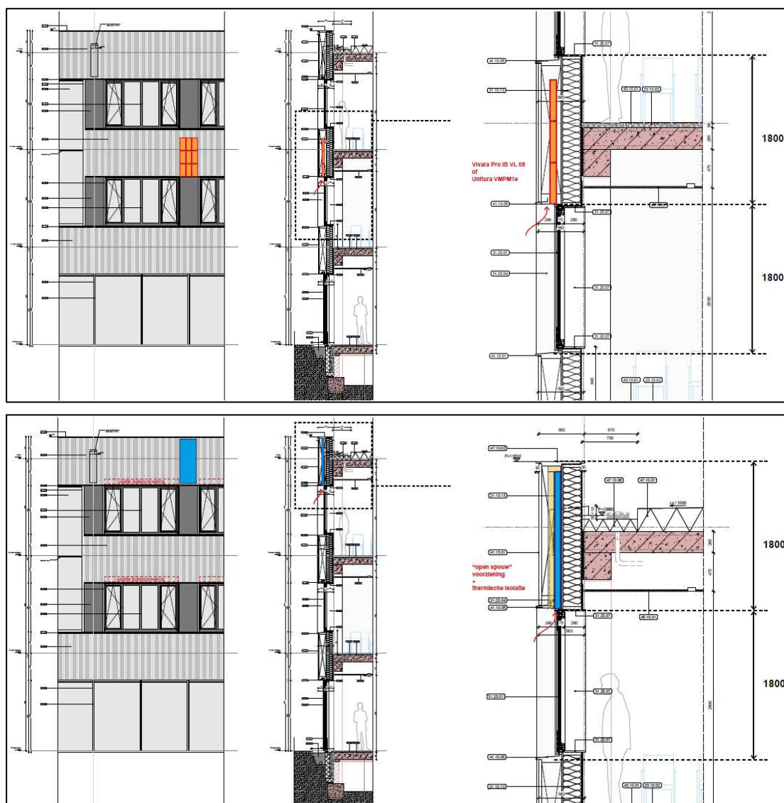
Figuur 3. De wijze van clustering en plaatsing van permanente kasten voor de gewone dwergvleermuis (boven) en de wijze en locatie van aanbrengen van ruimtes in de spouwmuur voor laatvlieger (onder). De oranje vlakken weergeven 9 geclusterde kasten, welke op 8 locaties aangebracht worden (= 72 kasten van het type IB VL 06/07 van Vivara pro of VMPM1 van Unitura). De blauwe ruimtes op de onderste afbeelding weergeven de locaties van een open spouwmuur over een lengte van ca. 1.70 tot 1.80 meter met toegang via een invliegopening voor laatvlieger. De bruine/gele lijn weergeeft een extra isolatielaag aan de buitenzijde/zijde van de wandbekleding voor voldoende temperatuur buffering. Alle wanden zijn voorzien van ruw materiaal/opgeruwd.
