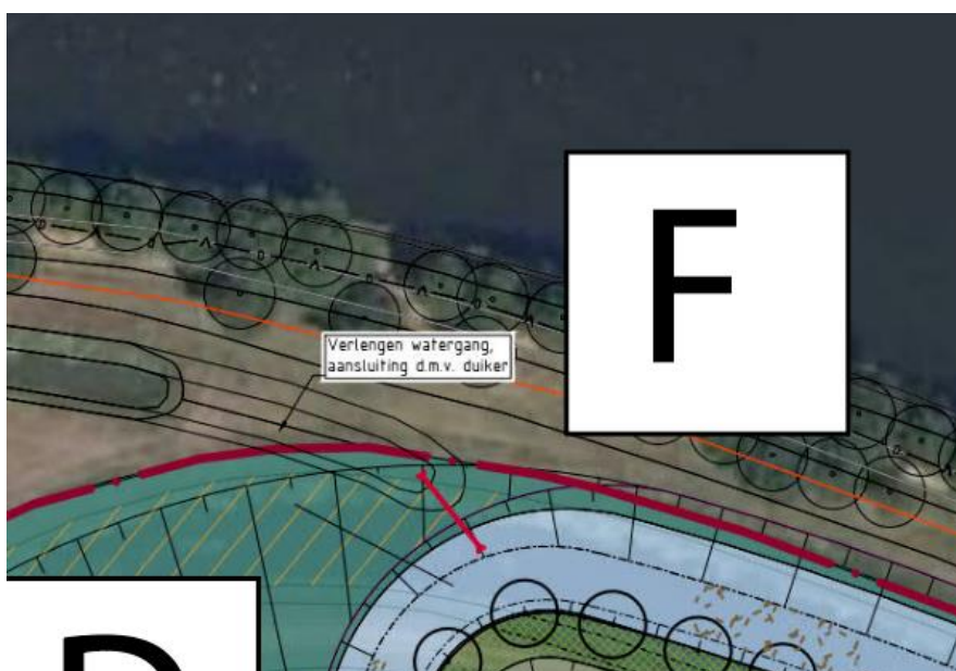
Figuur 21: Afwateringssloot Aarle-Rixtel met nieuwe duiker aansluiten op de Aa
