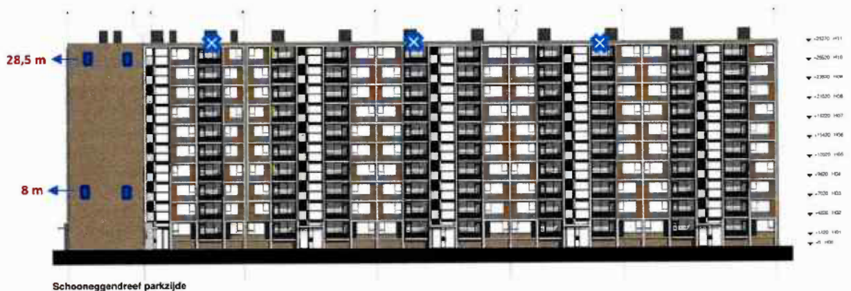
Figuur 5.6 Locaties en hoogtes van inbouwstenen en verblijfplaatsen dakrand op gevels Schooneggendreef Parkzijde. (bron: Door Architecten, 2022)
