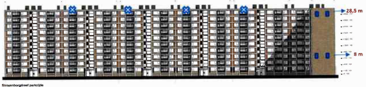
Figuur 5.7 Locaties en hoogtes van inbouwstenen en verblijfplaatsen dakrand op gevels Stroyenborchdreef Parkzijde. (bron: Door Architecten, 2022)
