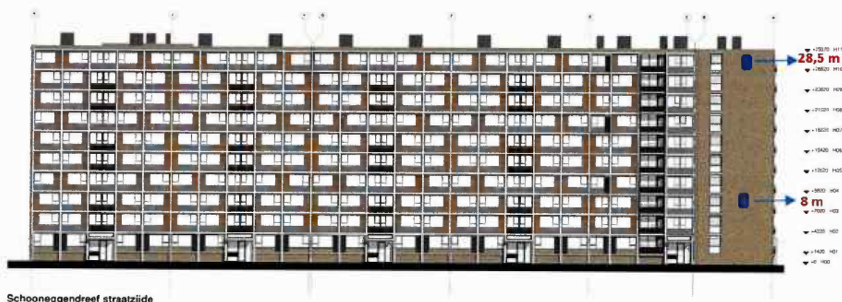
Figuur 5.5 Locaties en hoogtes van inbouwstenen op kopgevel Schooneggendreef Straatzijde. (bron: Door Architecten, 2022).
