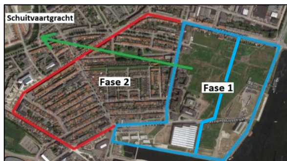
Figuur 2: Fasering van de afwatering.
