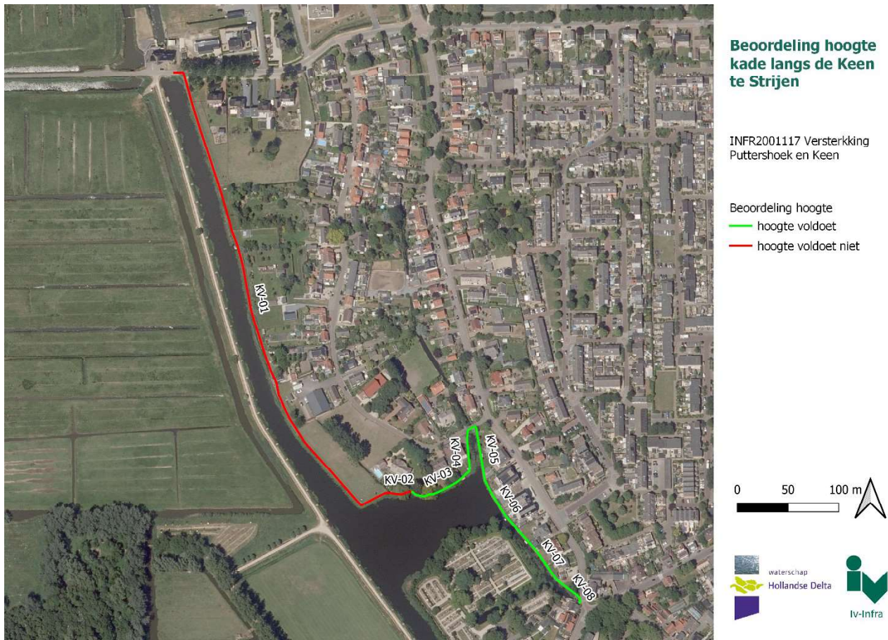
Figuur 4: Hoogte oordeel De Keen, kadevak 01 en 02 voldoen niet (rood), resterende kadevakken voldoen (groen)
