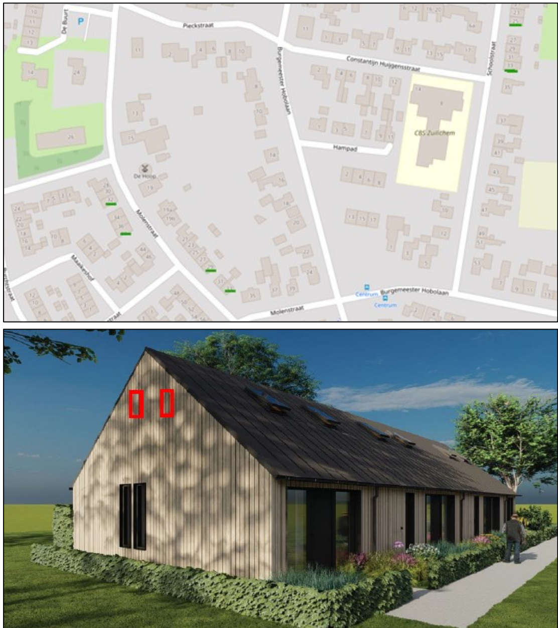
Figuur 2. De locaties van de tijdelijke voorzieningen in de vorm van 8 vleermuiskasten van het type VMT1 van Unitura, verdeeld over 6 locaties (groene balkjes, bovenste afbeelding). Op de onderste afbeelding is een schets van één van de woningen in de nieuwe situatie weergegeven met de beoogde locaties van de (8) permanente inbouwkasten van het type VMPPM1e (4) en VMPPM2e (4) van Unitura (of soortgelijk).
