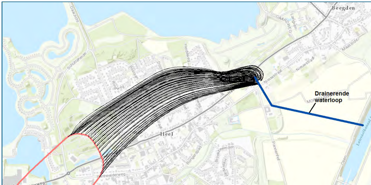
Figuur 12: Berekende stroombanen onder invloed van een drainerende waterloop
