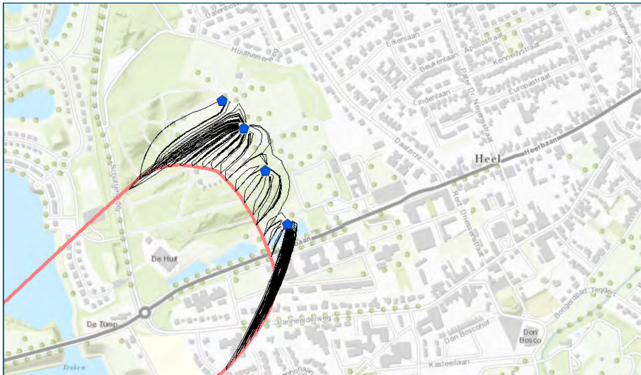
Figuur 13: Berekende stroombanen en situering interceptieputten
