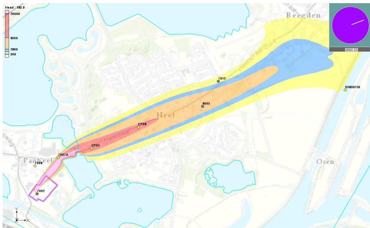
Figuur 13 | Verontreinigingsbeeld op circa 30 m-mv bij een maximale bronterm van 1 miljoen \mu\text{g/l} én een verdubbeling van het onttrekkingsdebiet van Waterproductiebedrijf Heel. De verontreiniging verplaatst zich veel noordelijker en 'verwaait' door de invloed van het Lateraalkanaal en puttenveld Het Langven.
