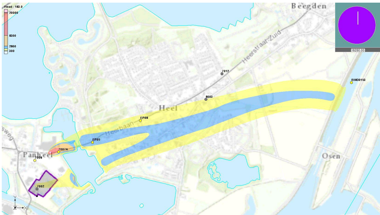
Figuur 21 | Stoftransportberekening laag 30 m -mv (gevoeligheidsanalyse en kalibratie)
