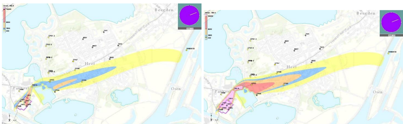
Figuur 11 | Voorbeeld van te hoog en te laag berekende concentraties bij verschillende aannames voor de brontermconcentraties. Links: in 2018 gemeten bromide concentraties als bronterm (Ia). Rechts: 0,5 M \mu g/l bromide als bronterm (Ib).
