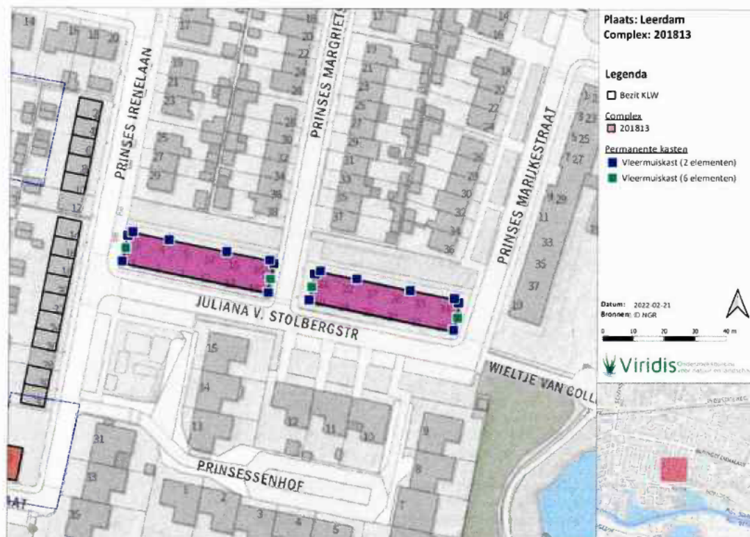
Figuur 2.2 | Overzichtkaart met permanente mitigatie. Groen = inbouwkast IB VL 06 geschakeld met vijfтал IB VL 07, blauw = inbouwkast IB VL 06 geschakeld met één IB VL 07.
