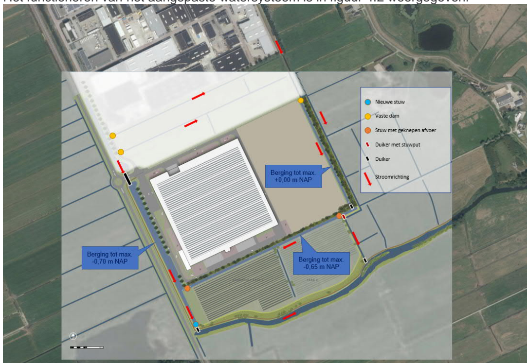
Figuur 4.2 Functioneren nieuw watersysteem
