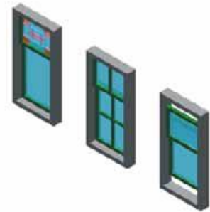
Oorspronkelijke kozijnen uit de bouwperiode van voor 1900
