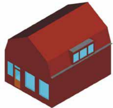
Dakkapel in mansardekap in onderste dakvlak plaatsen en aansluiten op knik
