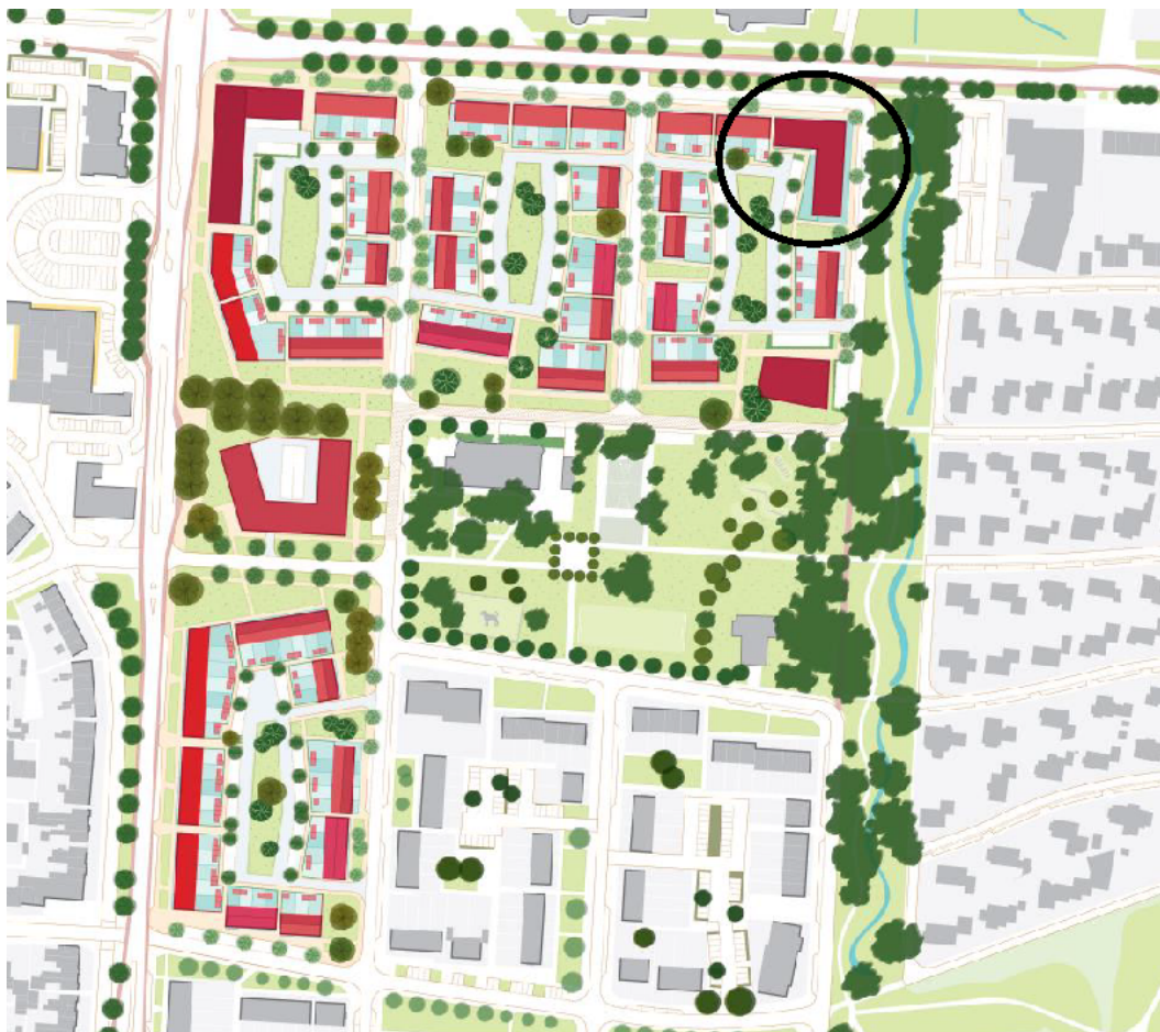
Figuur 5: Permanente mitigatie voor de kraamverblijfplaats. Binnen de cirkel worden 4 grote Tichelaarkasten ingebouwd.
