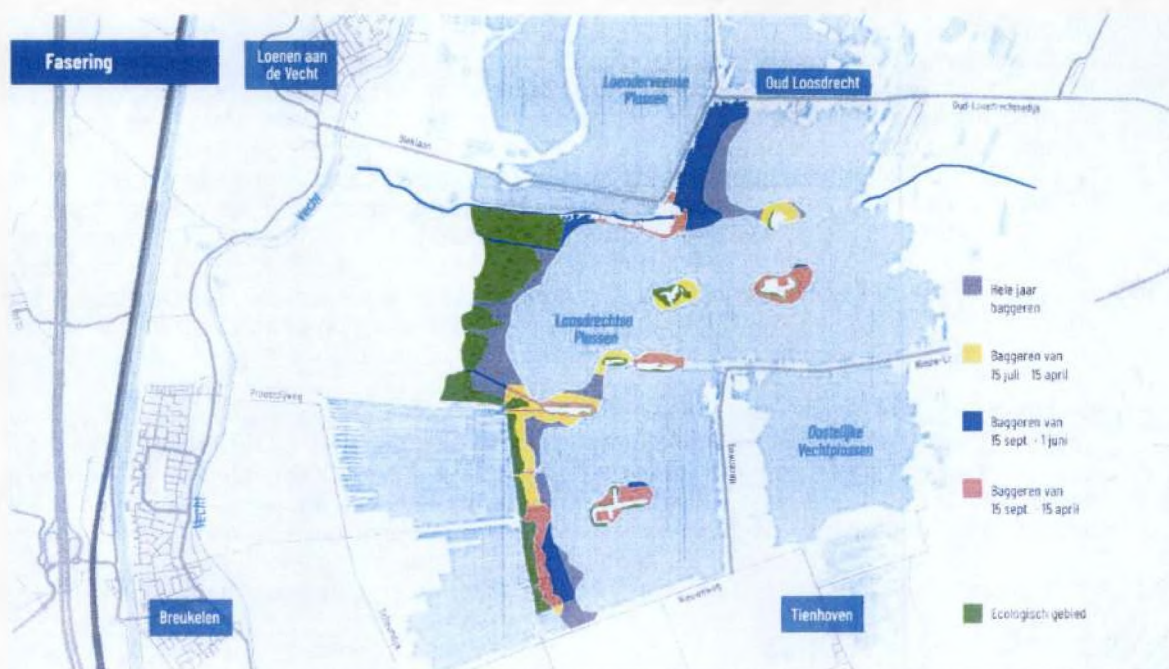
Afbeelding 2. Fasering baggerwerkzaamheden Loosdrechtse Plassen
