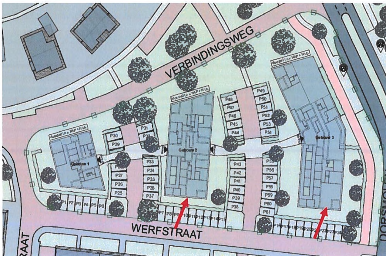
A. Plaatsing inbouwkasten (rode pijl, per pijl twee inmetsele kasten).
