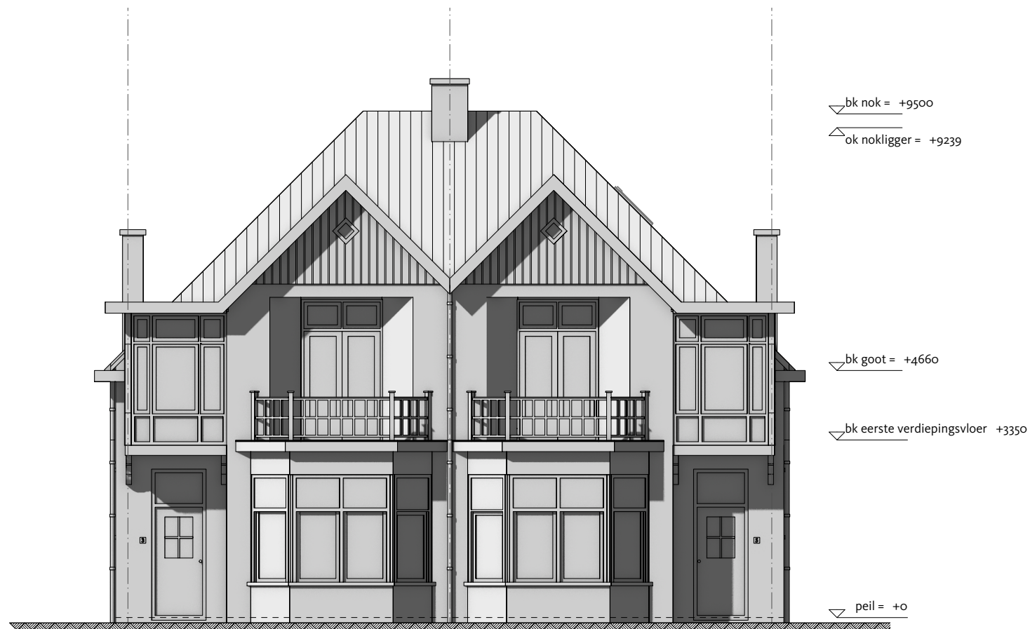
L(21)o6 voorgevel bestaand 1:100
