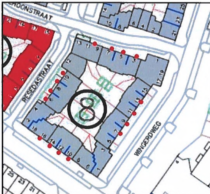
B. Locaties met permanente alternatieve vleermuisverblijven d.m.v. gaten in de gootbakken. Per rode stip = 1 opening in de gootbak.
