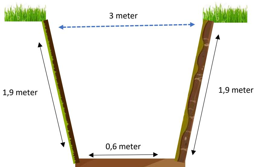
**2. Dwarsprofiel van de te verbreden waterloop:**
