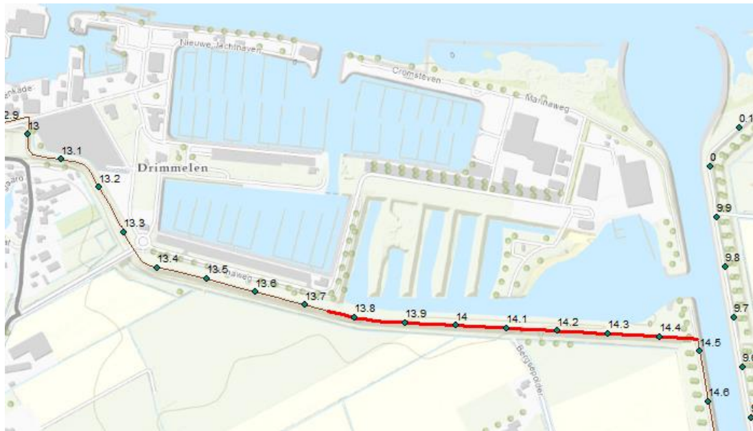
Figuur 1.1 Gedeelte van de Standhazensedijk dat is afgekeurd
