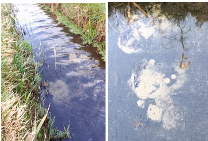
Figuur 2.6: Foto's van zandmeevoerende wellen in teensloot.
