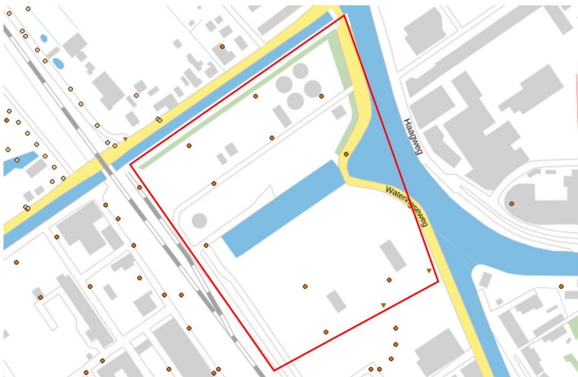
Afbeelding 3.2 Locaties grondonderzoek. Driehoeken geven de locaties van de sonderingen aan, bollen de locaties van de boringen
