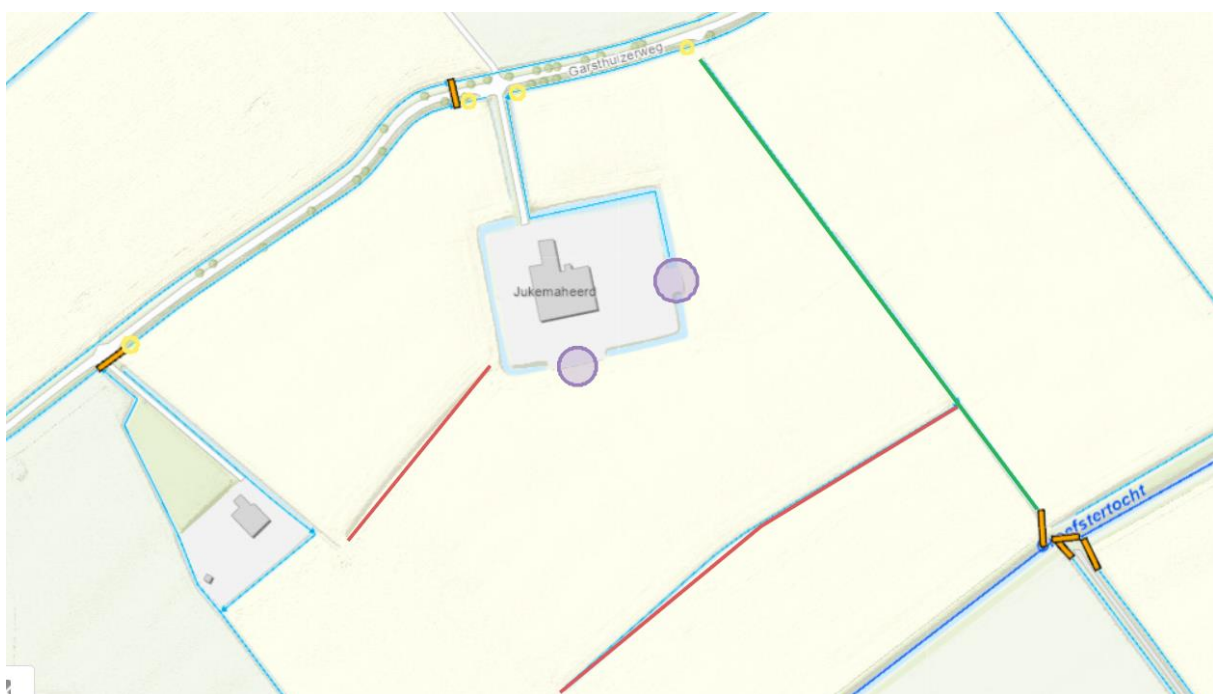
Figuur 1: Locatie van werkzaamheden. De rode lijnen geven te dempen watergangen weer. De groene lijn geeft te verbreden watergang weer. De gele cirkels geven aan te leggen of te verbreden dammen met duiker weer. De paarse cirkels geven te verwijderen dammen met duiker weer.
