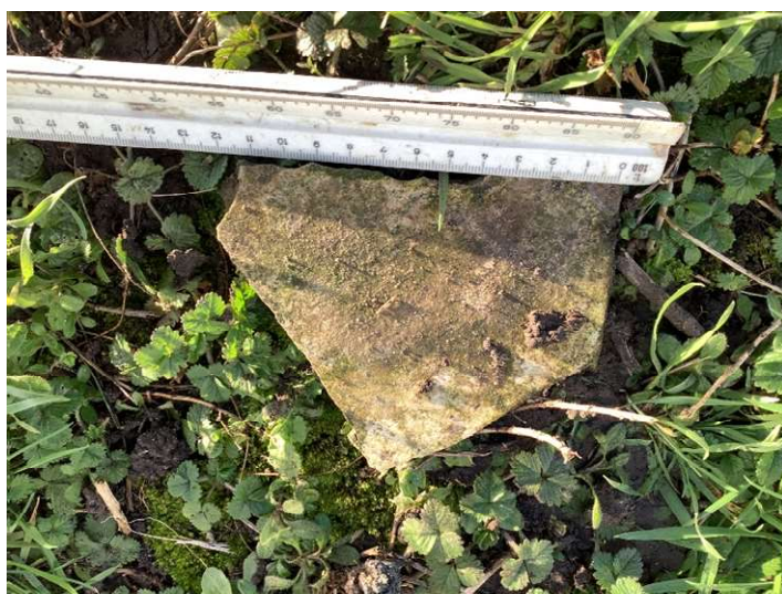
foto 8: asbesthoudend materiaal op het maaiveld deellocatie 2
