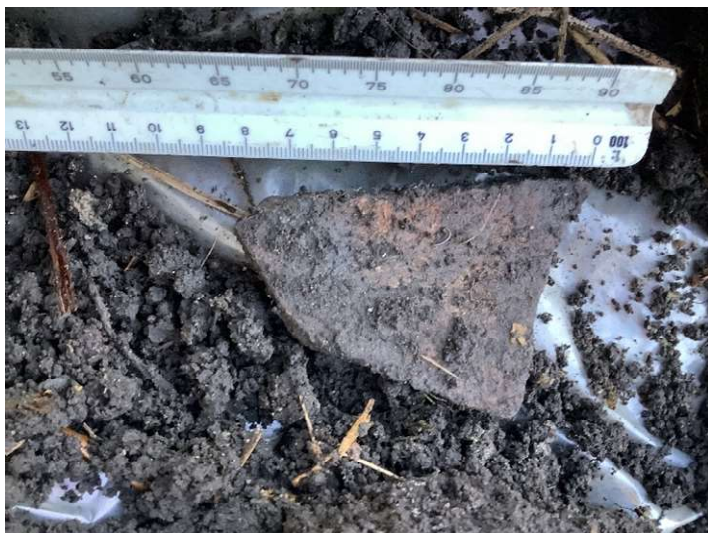
foto 5: asbesthoudend materiaal in de bodem deellocatie 1
