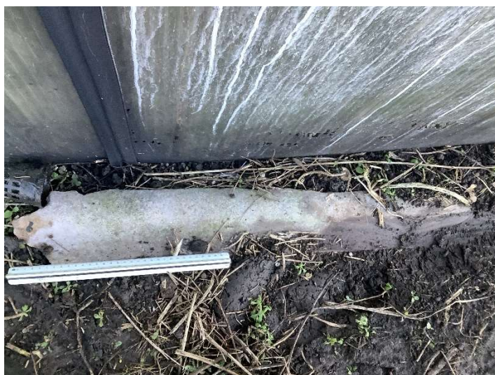
foto 4: asbesthoudend materiaal maaiveld deellocatie 1
