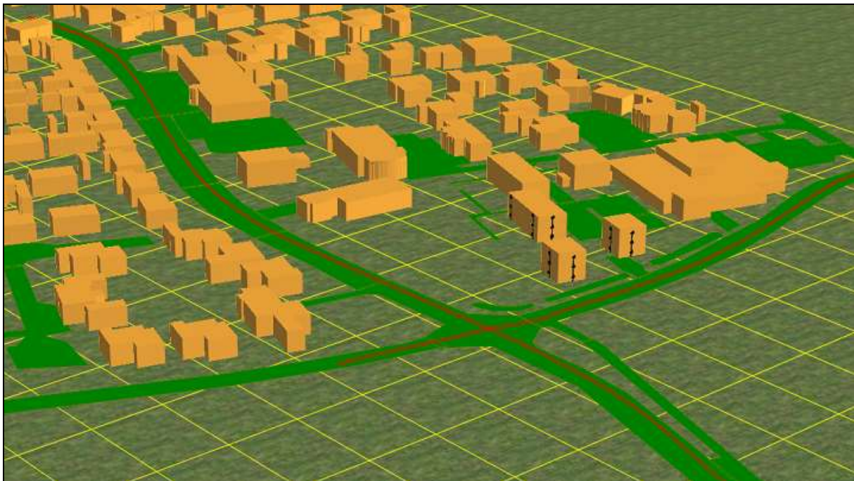
Afbeelding: 3D impressie van het rekenmodel voor wegverkeerslawaai
