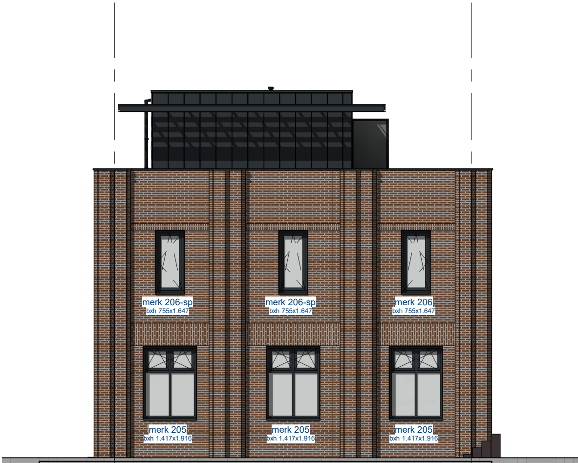
3 rechterzijgevel (west) schaal 1 : 100
