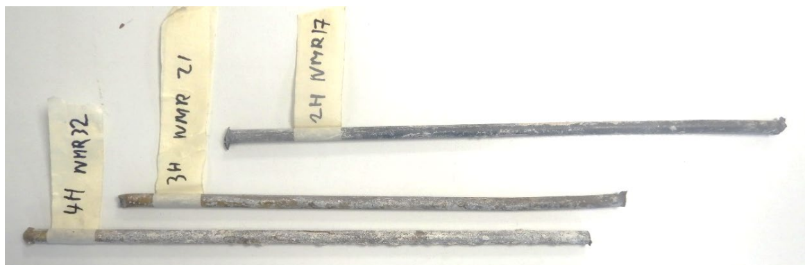
Figuur 3.3: Wapeningsstaven (1 e steekproef, november 2021)
