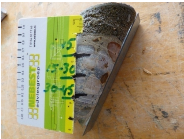
Figuur 5.1: Chlorideprofiel op drie dieptes van schuin geboorde kern uit de kim.
