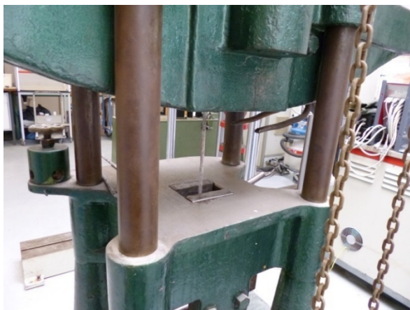
Figuur 5.5: Bepalen treksterkte op staal in laboratorium Nebest.
