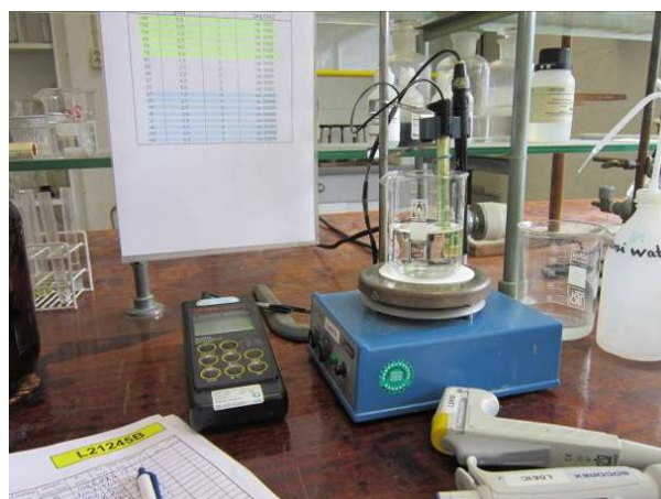
Figuur 5.8: Meting chloridegehalte stofmonsters in eigen laboratorium.
