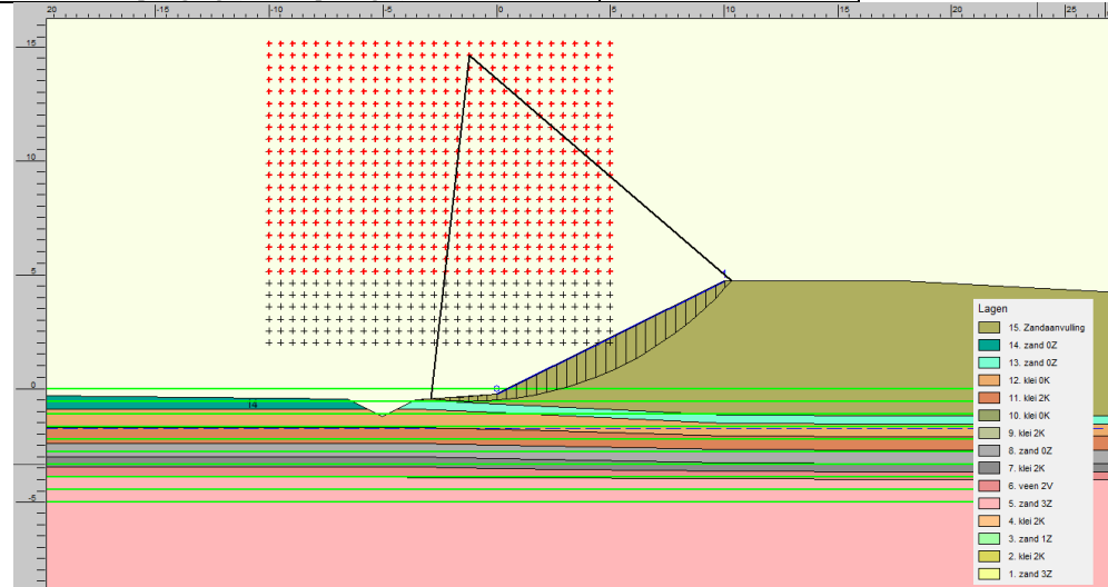
Figuur 20: Resultaten eindstabiliteit oost landhoofd Traverse; F_{min} = 1,47
