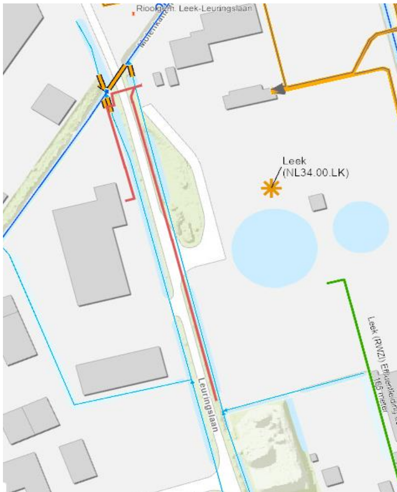
Figuur 1: De rode lijnen geven de locatie van de aan te leggen kabels weer.
