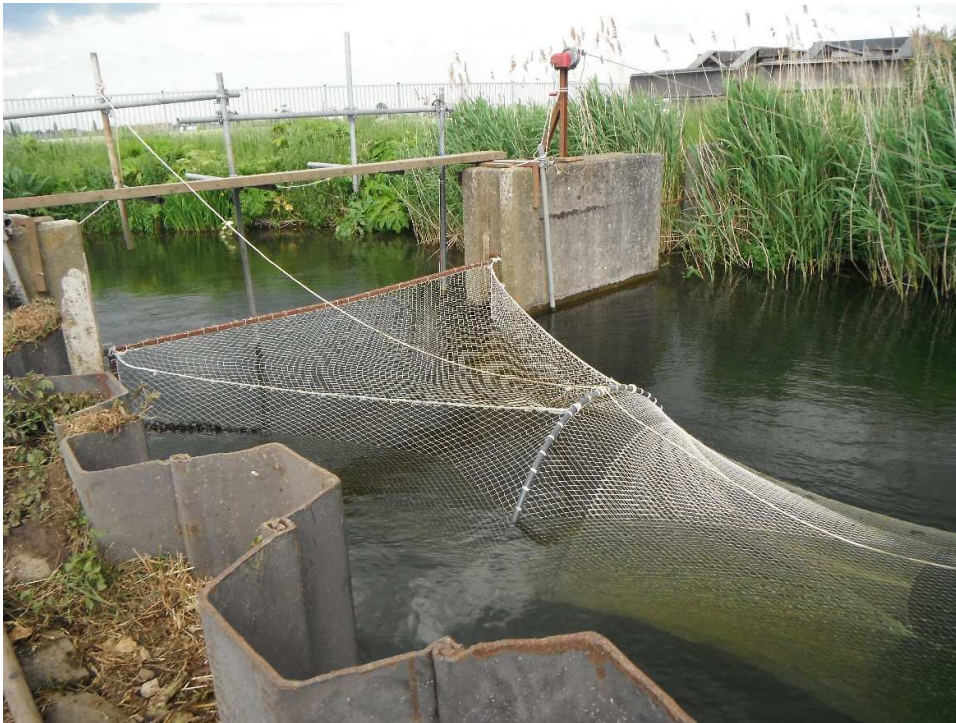
Figuur 4.7 Monitoringsvoorziening opgehangen in de sponningen bij een vispassage.
