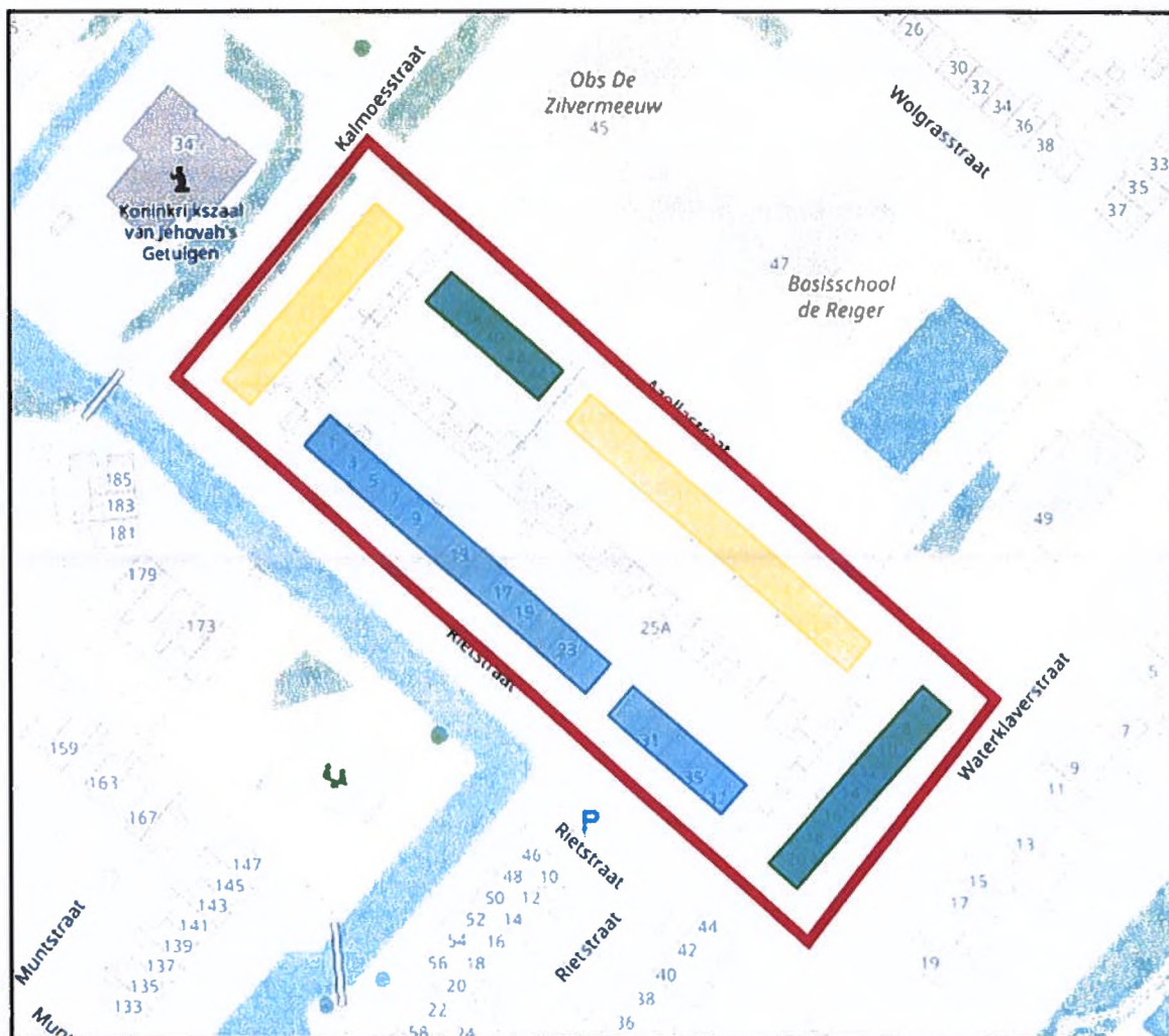
A. Fasering werkzaamheden waarbij gestart wordt met de blauwe blokken, vervolgens de groene blokken en als laatste de gele woonblokken.
