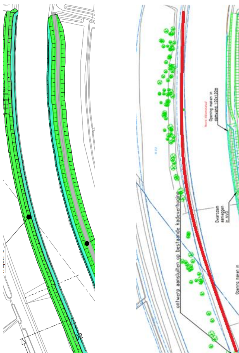
Figuur 2.4 Traject 3 in het oude ontwerp links en het nieuwe ontwerp rechts (met rood het reeds ingerichte deel op de westoever). Traject 3 betreft de westzijde van het Noord-Willemskanaal.
