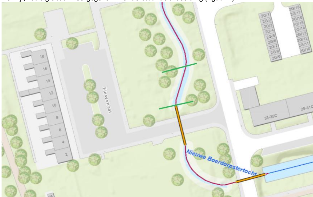
Figuur 1: Kruisingen kabeltracé/watergang aangegeven met groene lijnen.
