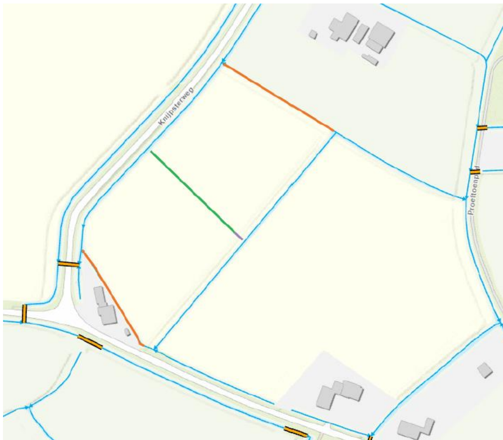
Figuur 1: De oranje lijnen tonen de te dempen watergangen en de groene lijn toont de nieuw aan te leggen secundaire watergang met aan de oostkant een dam, paarse lijn.
