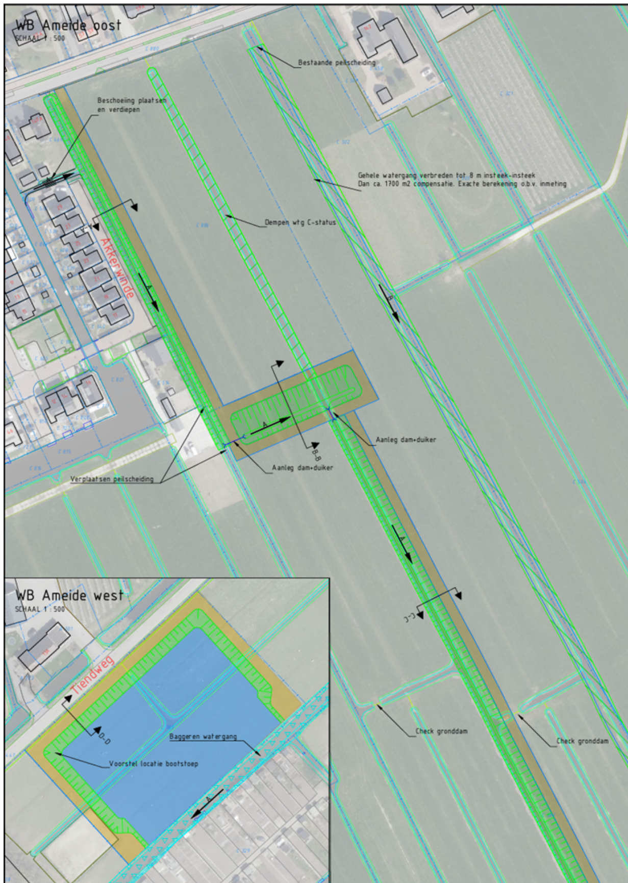
Figuur 2 Schetsontwerp van de waterbergingslocatie Ameide West en Oost. (Bruin: onderhoudspaden met draaiplaatsen). Voor waterbergingslocatie Ameide West is al een apart projectplan opgesteld met kenmerk: 2022039718 / 2022039927
