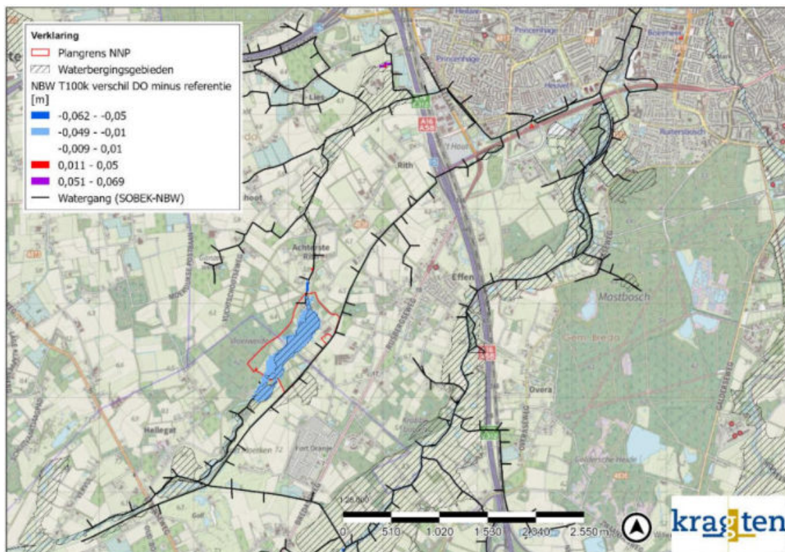
Afbeelding 33. Verschil in inundatie bij een NBW 1:100k als gevolg van het DO (DO minus referentie inundatie).
