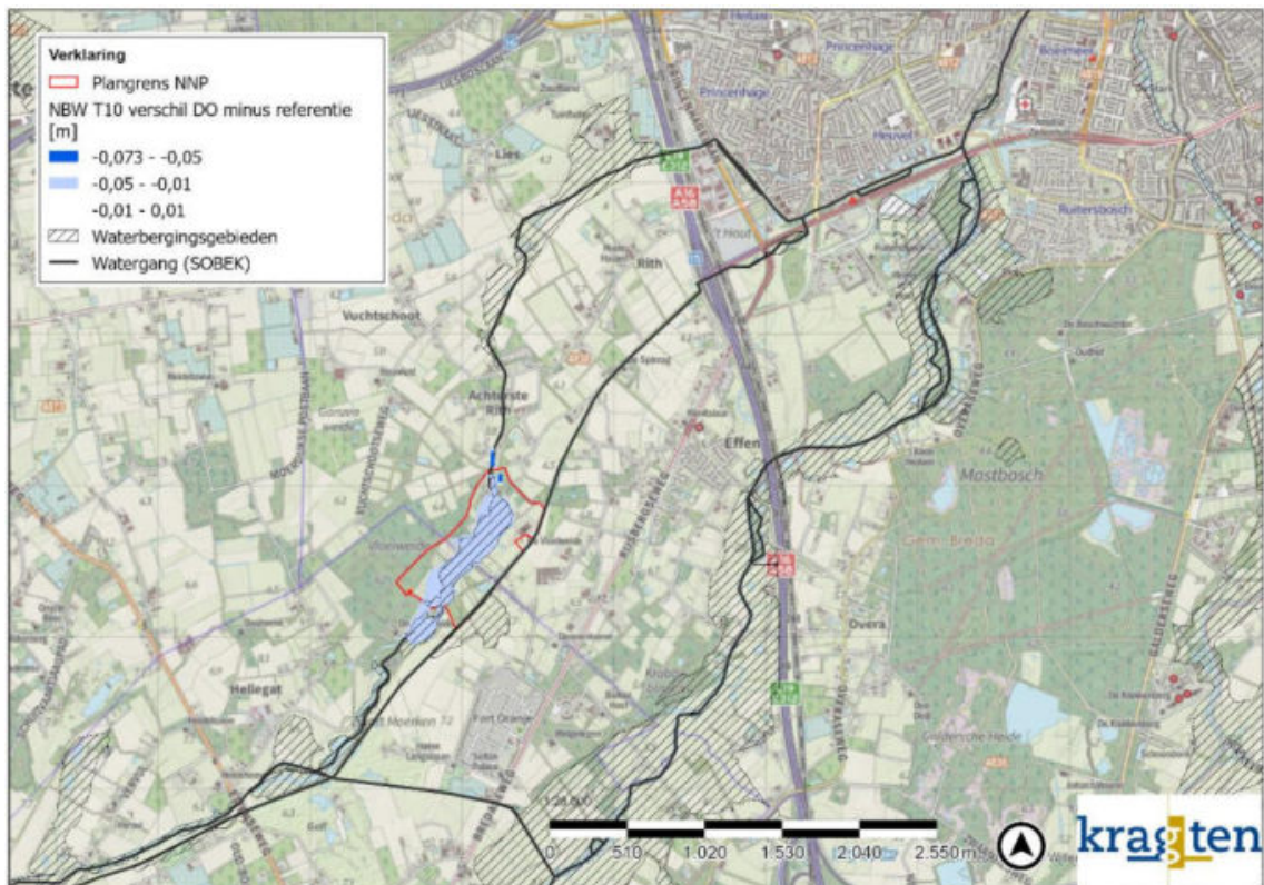
Afbeelding 35. Verschil kaart van inundatie bij een T10 waarbij de referentiesituatie van de nieuwe situatie (DO) is afgetrokken.
