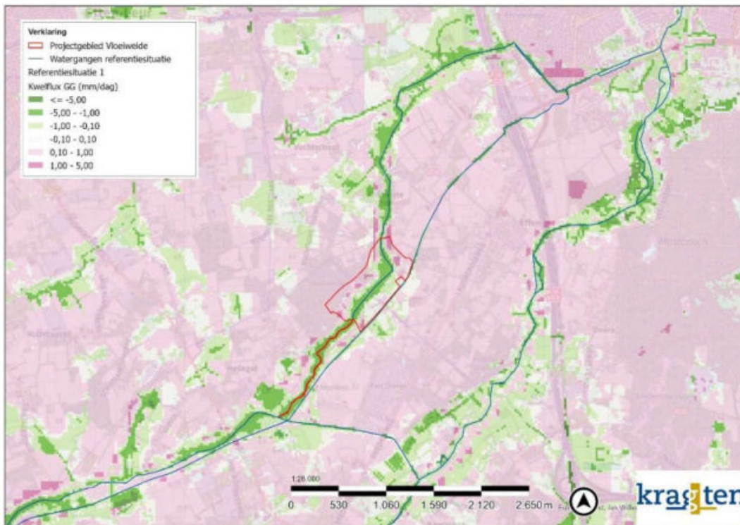
Afbeelding 8 Kwelflux in referentiesituatie 1, negatieve waarden (groen) is kwel en positieve waarden (roze) infiltratie
