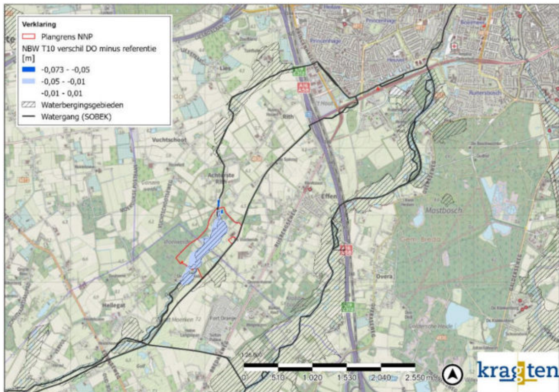
Afbeelding 32. Verschil in inundatie bij een NBW T10 als gevolg van het DO (DO minus referentie inundatie).
