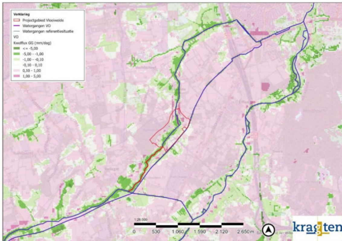
Afbeelding 50 Kwelflux in de VO-situatie, negatieve waarden (groen) is kwel en positieve waarden (roze) infiltratie
