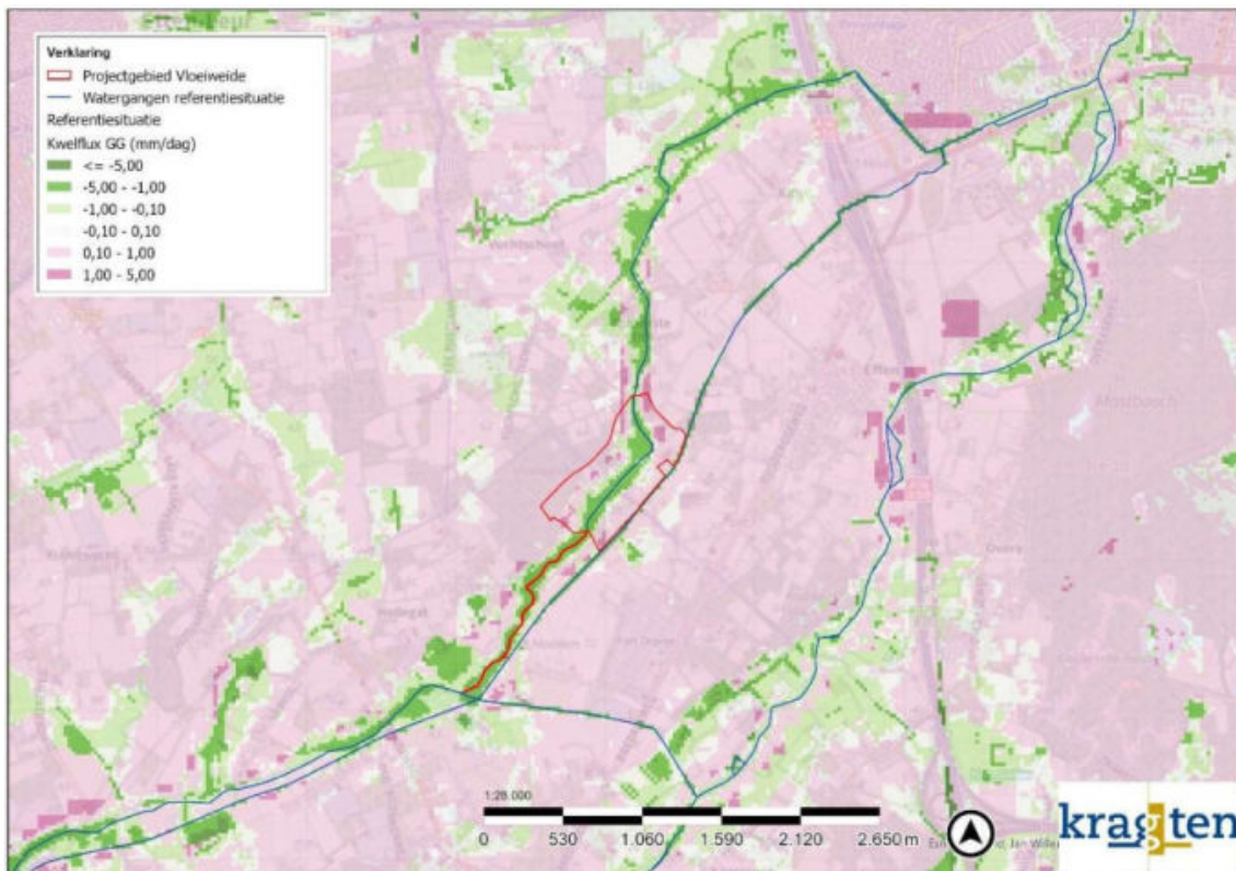
Afbeelding 13 Kwelflux in referentiesituatie 2, negatieve waarden (groen) is kwel en positieve waarden (roze) infiltratie
