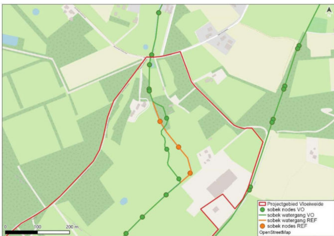
Afbeelding 40 Ligging rekenpunten SOBEK voor het referentiemodel en voor het Voorlopig Ontwerp (gewijzigde ligging waterloop)
