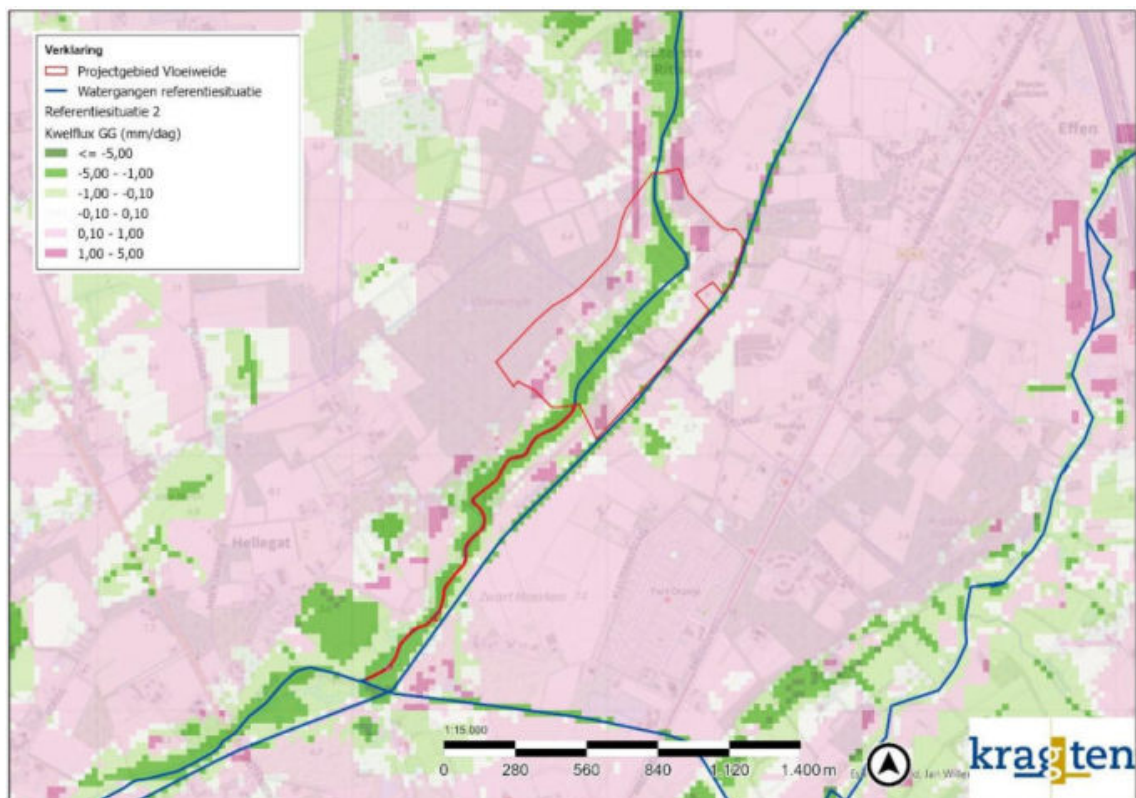
Afbeelding 5. De kwelflux in millimeter per dag. Een positieve waarde duidt op kwel en een negatieve op infiltratie (bron: Brabant model).
