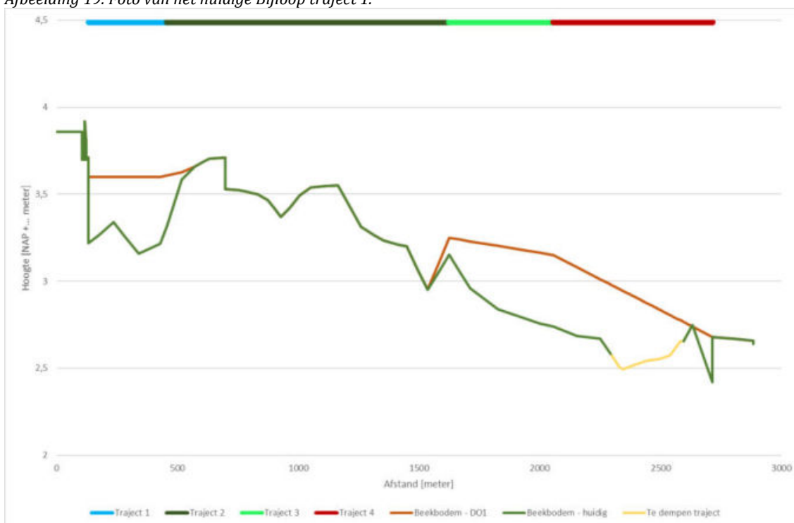
Afbeelding 20. Beekbodemprofiel van huidige situatie (groen) in combinatie met toekomstige situatie (rood/bruin).
