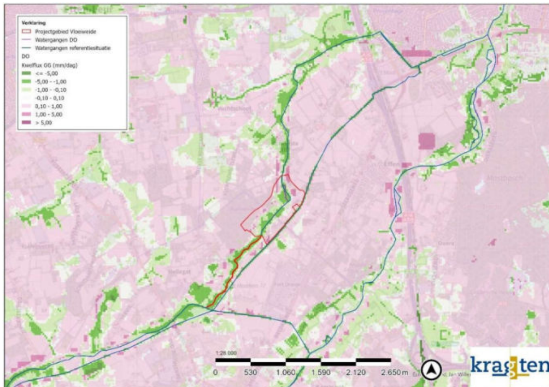
Afbeelding 38 Kwelflux in de VO-situatie, negatieve waarden (groen) is kwel en positieve waarden (roze) infiltratie
