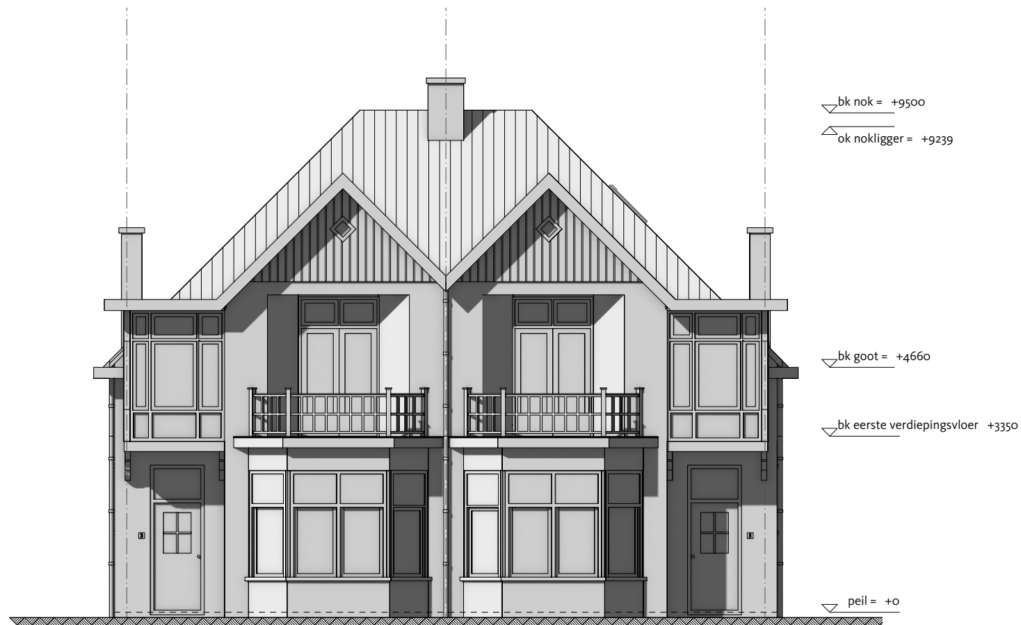
L(21)o6 voorgevel bestaand 1:100
